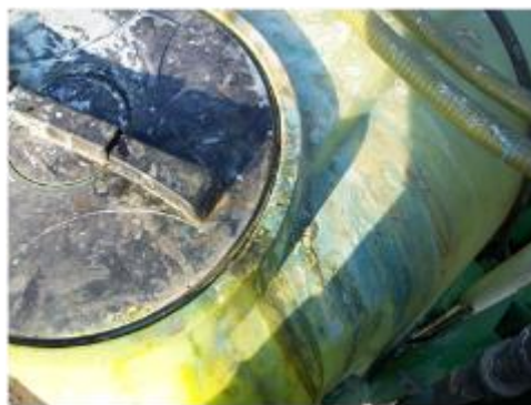
Cierre deficiente de la tapa del depósito.
