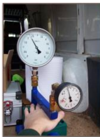
Diferentes tipos de contrastadores de manómetros.
