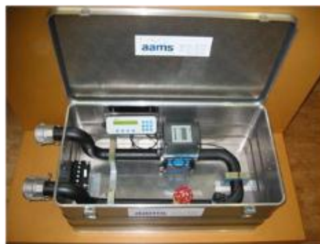
Instrumentación para la medida de la capacidad de la bomba.
