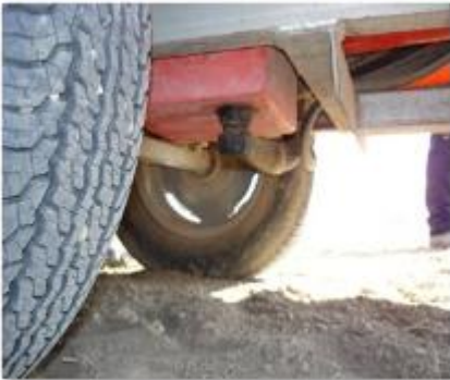
Sistema de vaciado de accionamiento difícil.
