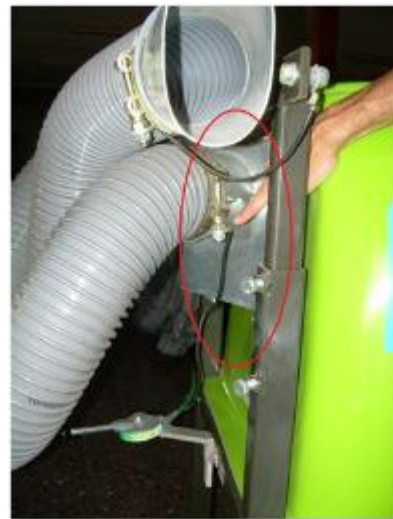
Partes metálicas del equipo conectadas entre si.
