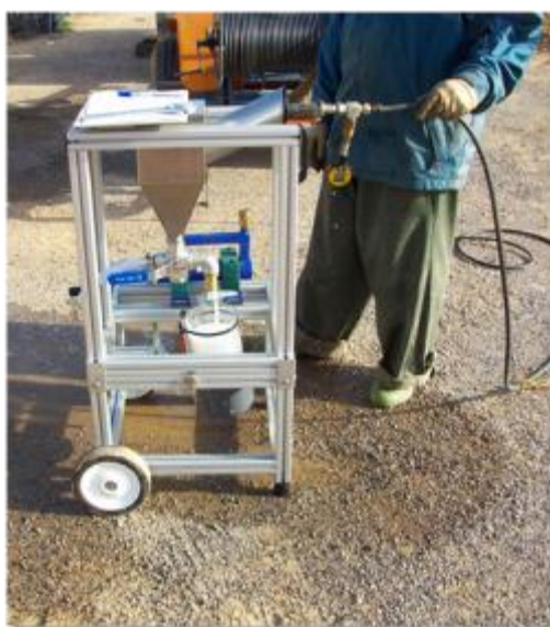
Recogida del líquido de una pistola de pulverización con una probeta graduada.
