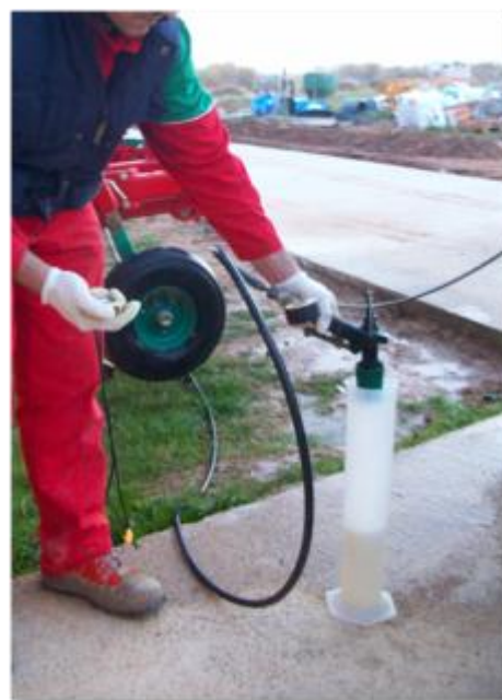
Recogida del líquido de una pistola de pulverización con una probeta graduada.
