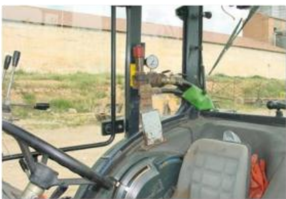
No se permite la presencia de circuitos a presión dentro de la cabina del tractor.
