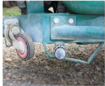
Sistema de vaciado de accionamiento difícil.
